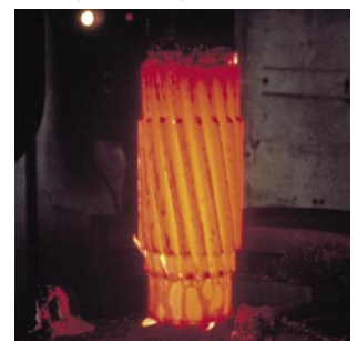
Wärmebehandlung: sämtliche Zahnäder werden gehärtet und geschliffen
